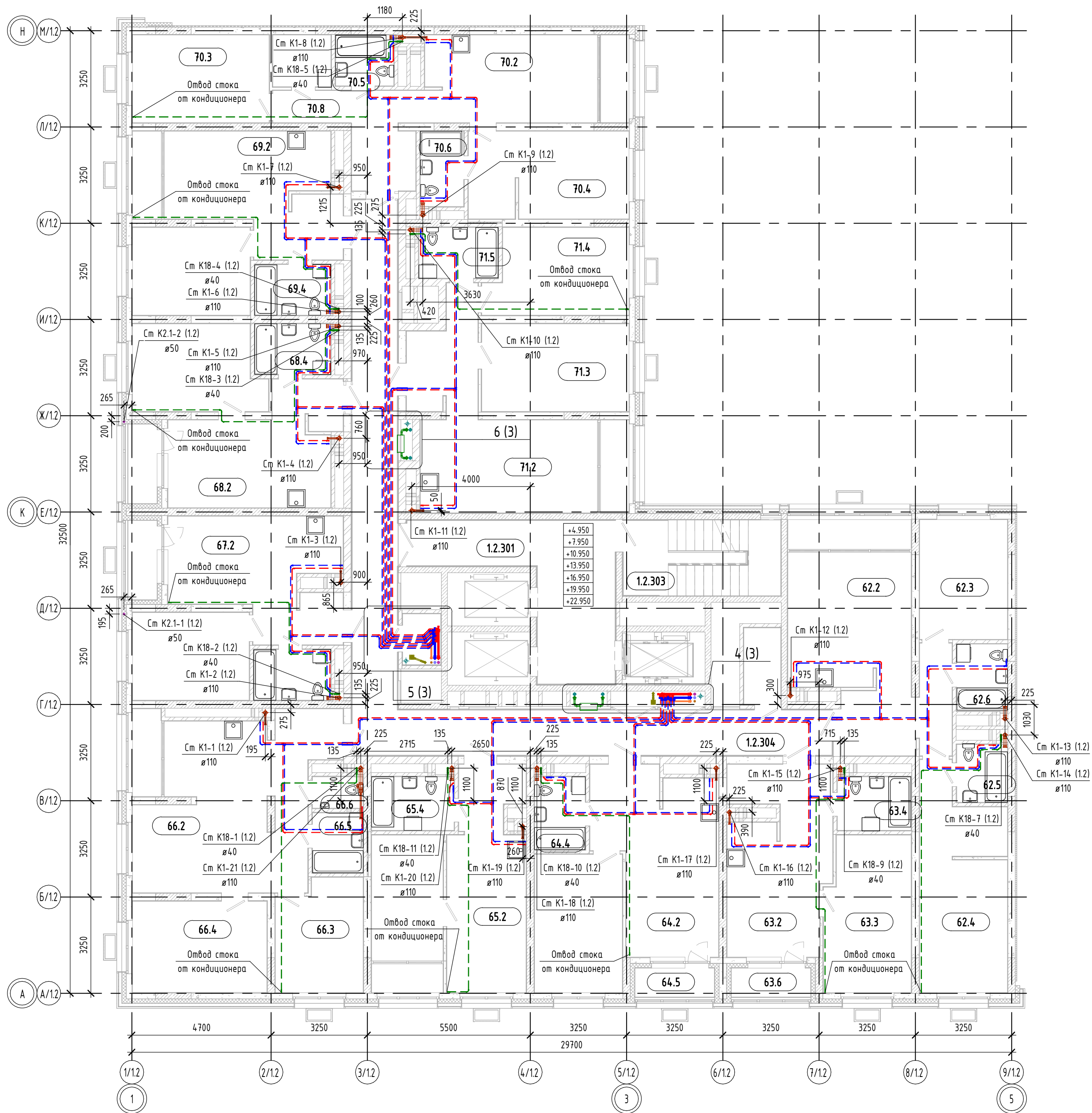
План 2-8 этажа с системами водоснабжения и канализации
