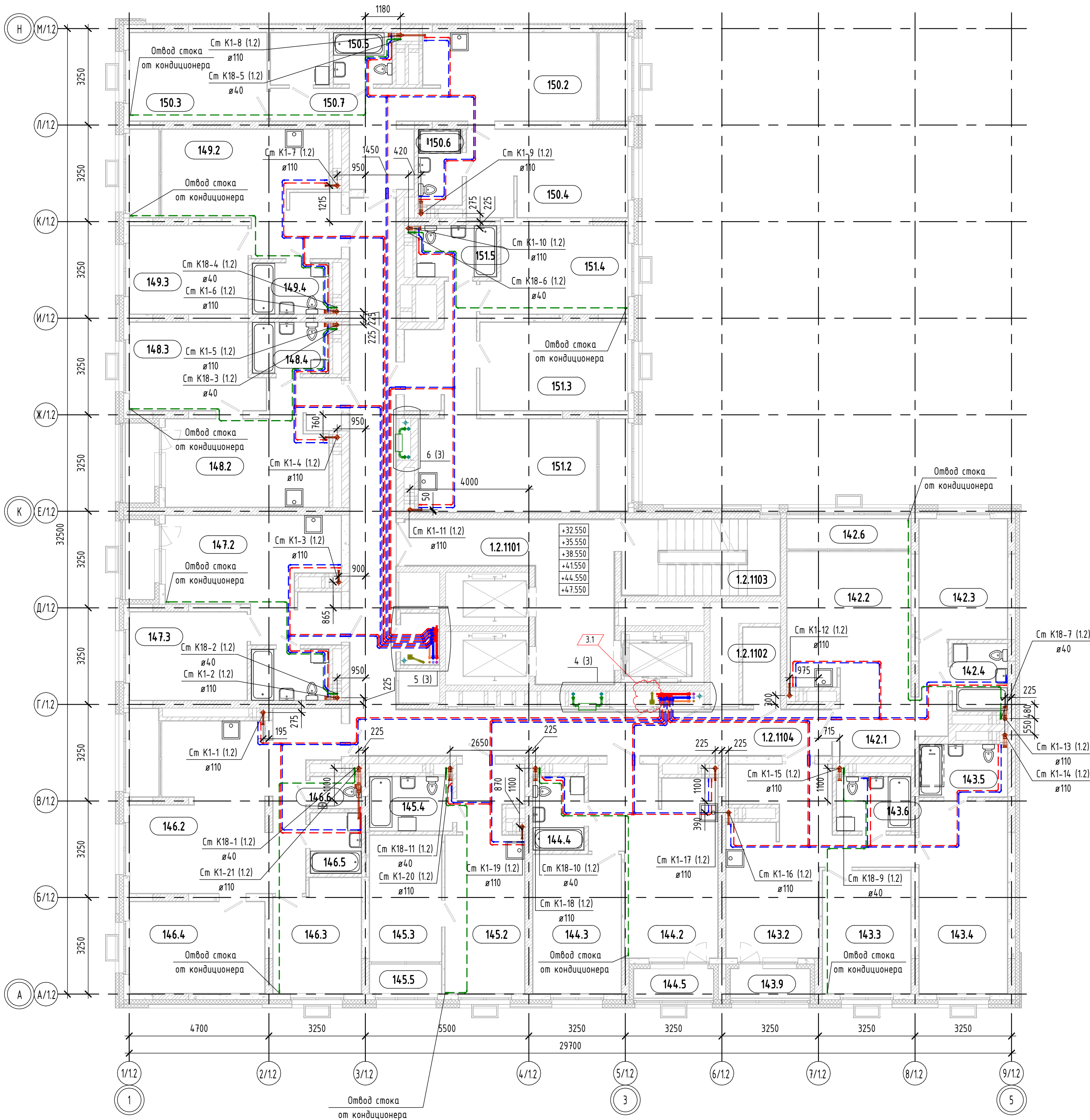
План 11-16 этажа с системами водоснабжения и канализации
