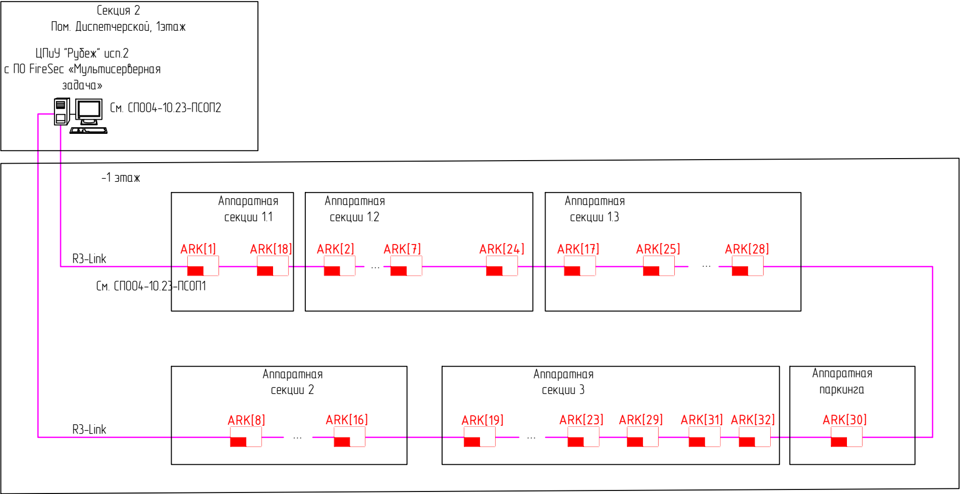
Схема обвязки оборудования ПС, посредством протокола R3-Link
