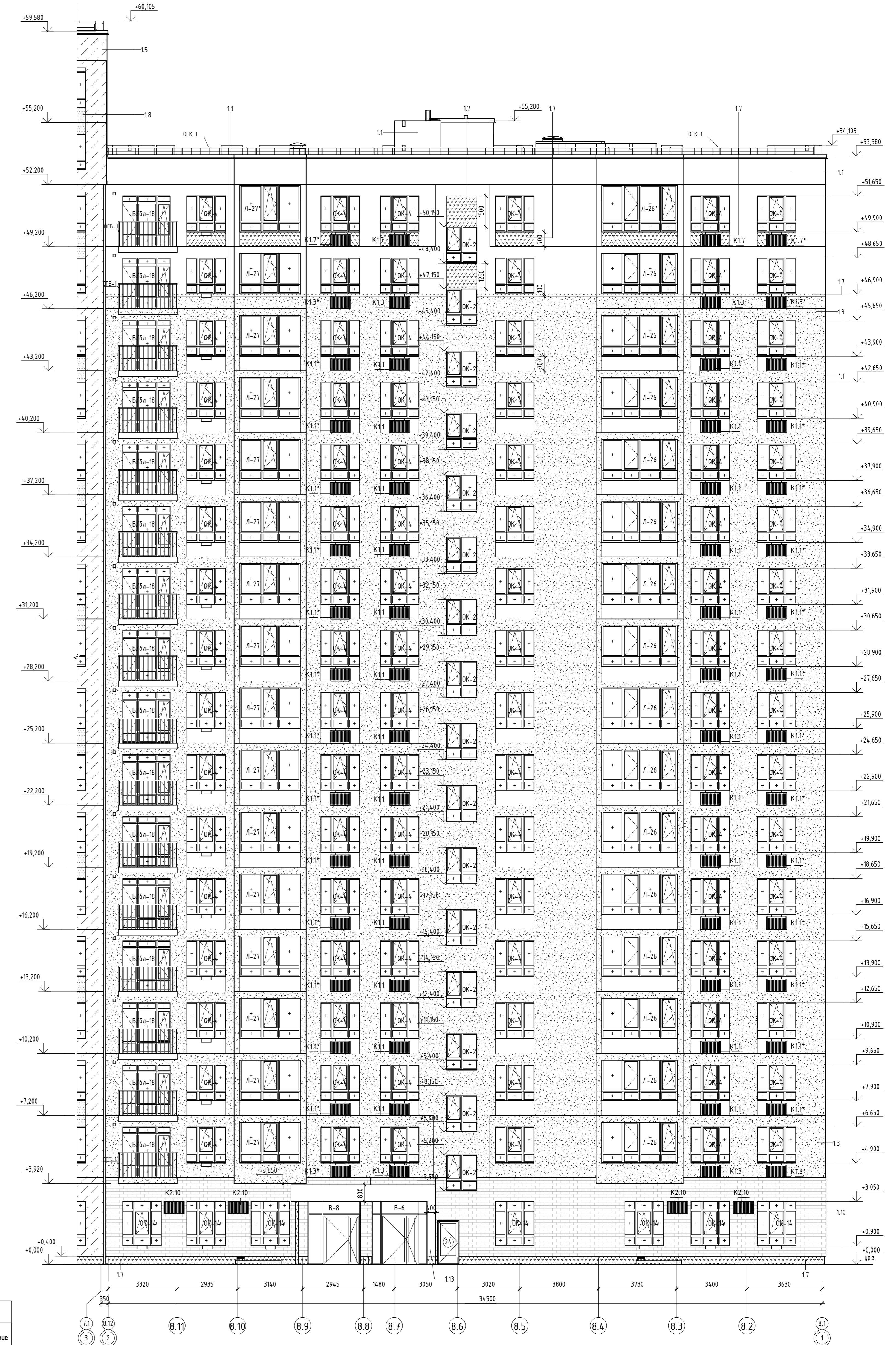
Фасад в осях 2-1 (1:100)
