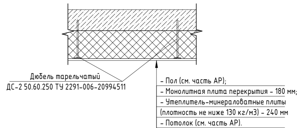
Узел утепления потолка тамбура
